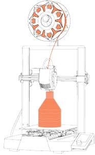
FDM方式（熱溶解積層造形方式）
